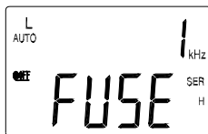
Figura 6. Detección de fusible
